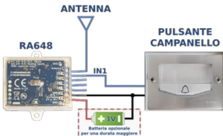
Si può configurare RA649 in modo che un canale abbia la funzione di relè uomo presente per comandare il campanello, mentre l'altro canale avrà la funzione di relè temporizzato per comandare la luce di cortesia il tutto comandato da un unico codice.
