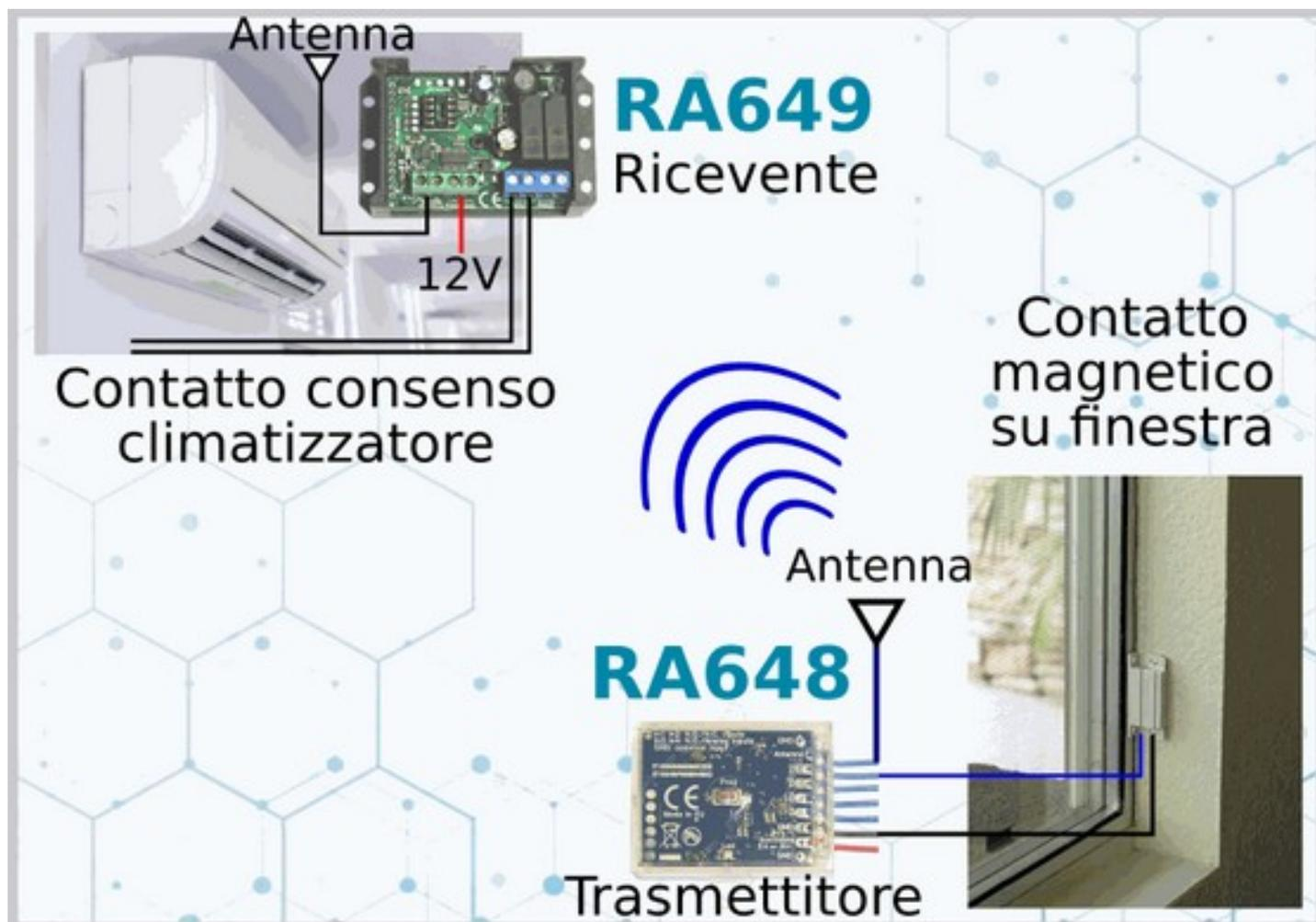
A volte negli alberghi si preferisce evitare di scavare nuove tracce o rompere piastrelle per fare i collegamenti così il segnale di finestra aperta/chiusa viene inviato tramite un radiocomando a batterie, e la soluzione a questo caso può essere ottenuta con un telecomando RA648 collegato al sensore, in abbinamento ad una ricevente RA649 associata al condizionatore.
