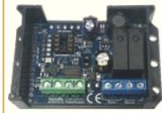
**RA649:** ricevente universale a 2 relè, 250Vac e 3A max. **Multifrequenza: 433.42+434.42 e 868.3+868.8MHz**, modulazione AM e FM.
