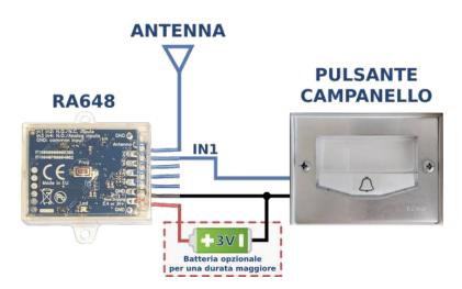
Si può configurare RA649 in modo che un canale abbia la funzione di relè uomo presente per comandare il campanello, mentre l'altro canale avrà la funzione di relè temporizzato per comandare la luce di cortesia il tutto comandato da un unico codice.
