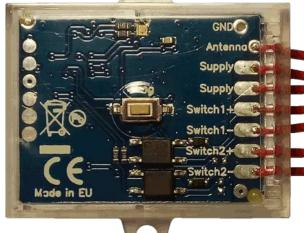
RA644 è una ricevente multi frequenza con 2 uscite a mosfet contatto pulito, 60V 50mA. Può essere installata in affiancamento a un'altra ricevente già presente di cui non si riesce a duplicare il radiocomando.
