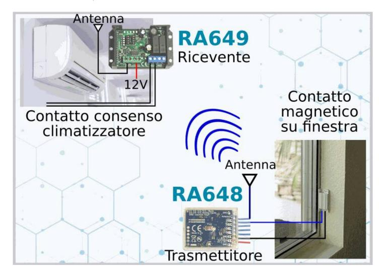
A volte negli alberghi si preferisce evitare di scavare nuove tracce o rompere piastrelle per fare i collegamenti cosi il segnale di finestra aperta/chiusa viene inviato tramite un radiocomando a batterie, e la soluzione a questo caso può essere ottenuta con un telecomando RA648 collegato al sensore, in abbinamento ad una ricevente RA649 associata al condizionatore.
