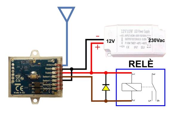
RA644 è una mini ricevente multifrequenza a 2 canali in bassa corrente e tensione. Per casi particolari, dove non si vuole utilizzare la ricevente RA649 con 2 Relè integrati, è possibile aggiungere uno o due relè a RA644 per poter pilotare così carichi con una corrente maggiore di 20mA e una tensione maggiore di 24V.
